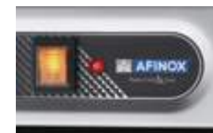
Indicador rojo encendido: falta agua
